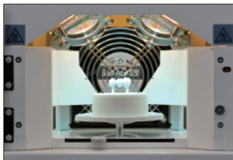
Četiri snažne halogene sijalice 150W svaka sa spektrom svetlosnog talasa 400-550 nm, garantuju efikasnu polimerizaciju u kompaktnoj polimerizacionoj komori.
